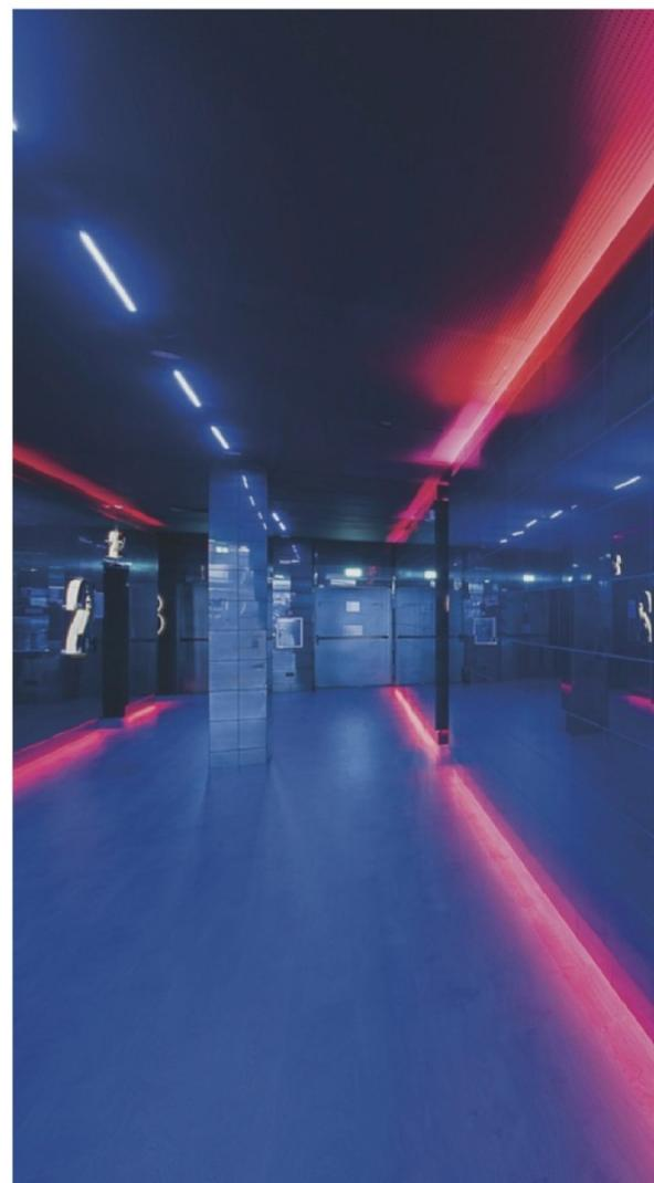
Gavirate, Cinema Multisala Electric. Disimpegni di accesso alle sale: qui sono state utilizzate LED strip RGB alloggiare in un recesso non visibile realizzato con la posa dei rivestimenti ceramici a muro dei corridoi (cortesia: studio HIT archITects, Milano)
